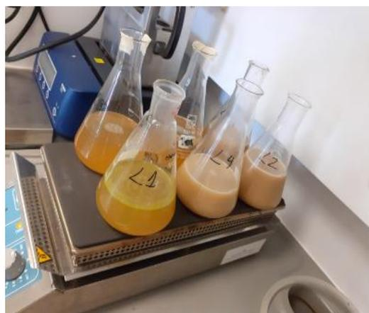
**Imagen 8:** Ebullición de las pruebas de amargos contenidos en levadura.
