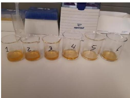
**Imagen 7:** Diferentes muestras de la prueba de amargos contenidos en la levadura. Muestra 1: Blanco, pellet de lúpulo conocido; Muestra 2: purga directa; Muestra 3: fase líquida centrifugación; Muestra 4: fase sólida centrifugación; Muestra 5: fase líquida vacío; Muestra 6: fase sólida vacío
