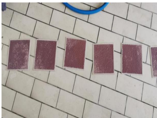
ILUSTRACIÓN 14 PLACAS DE FILTRACIÓN DE CERVEZA EN GUARDA FRÍA
