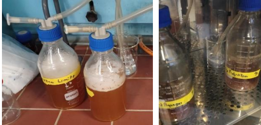
Imagen 3-Pruebas de fermentación a temperatura ambiente vs en estufa.
