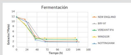
Figura 1: cinética de fermentación de diferentes cepas indicadas para IPA. Se preparó un mosto estándar de 12°P a partir de extracto de malta, inoculado con 100 g/hL de levadura y fermentado a 20°C.
