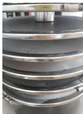
Figura 8. Interior del filtro de platos.
