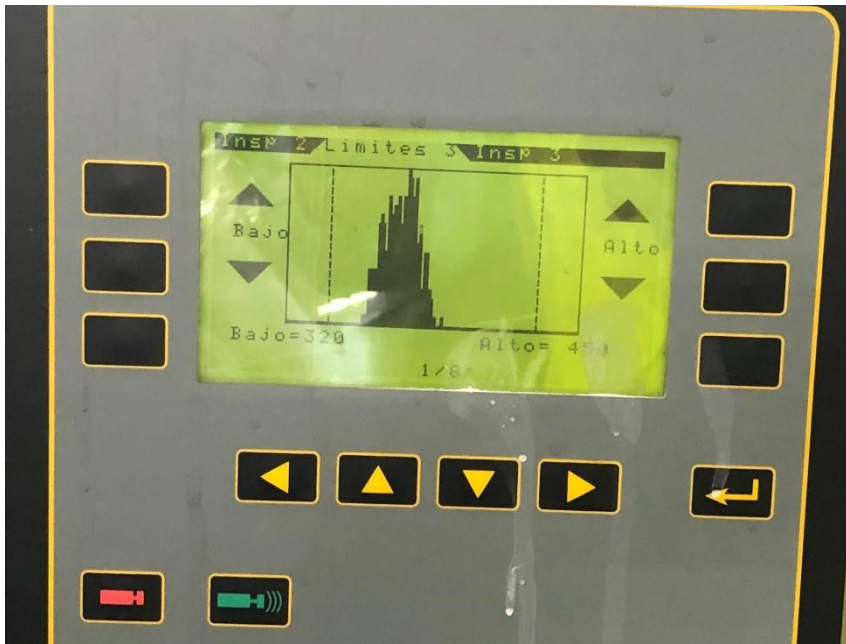
Ilustración 2: Dispositivo de ultrasonidos, para verificar estanqueidad botellas llenas.
