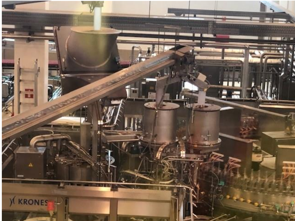
Ilustración 3: Transporte por cinta magnética.
