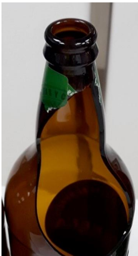
Ilustración 11: Botella rota por sobrepresión.
