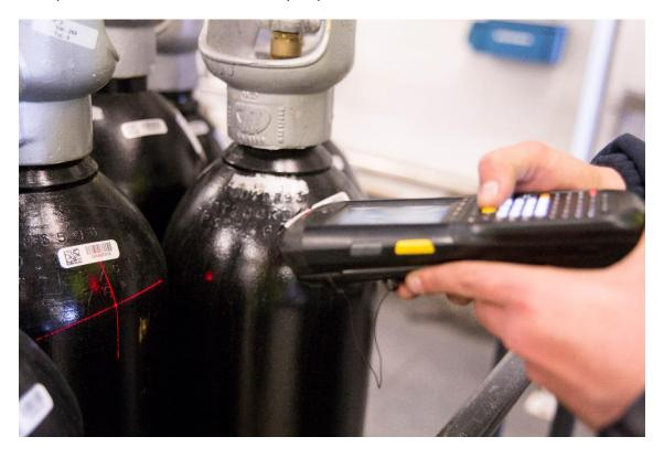
Además, las botellas de CO2 tienen una fecha de caducidad de 10 años, tras los cuales deben pasar una prueba hidráulica para comprobar que el envase conserve las propiedades físicas necesarias para soportar de forma segura la presión constante que causa el gas comprimido contenido en su interior. Por motivos legales, pero sobre todo por razones de seguridad, NO está permitido llenar ninguna botella que haya superado su fecha de caducidad sin realizar previamente la prueba hidráulica.
