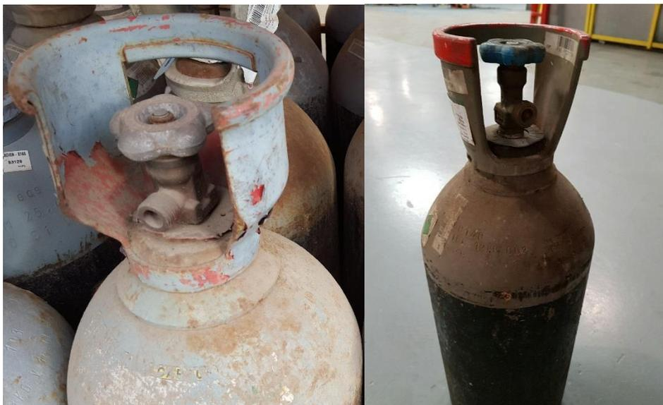
Fotografías 1 y 2. Detalle del estado de deterioro de las botellas recepcionadas.
