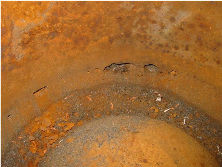
Fotografía 7. Detalle del grado de corrosión en la pared de una botella.
