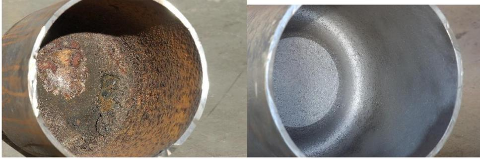
Fotografías 5 y 6. Detalle de una botella con corrosión interna y su aspecto después de realizar una limpieza interna.
