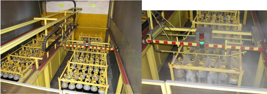
Fotografías 3 y 4. Disposición de las botellas en el túnel de lavado de AIRBOX, S.A. y detalle de su funcionamiento.
