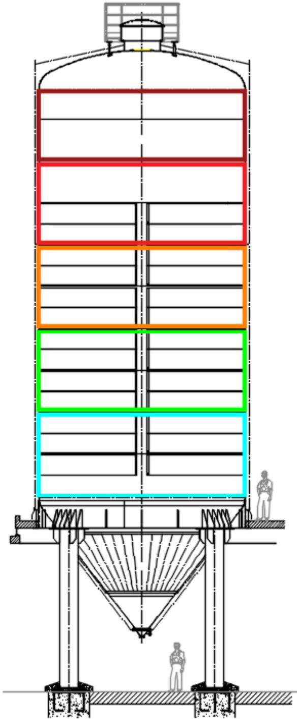
Dado que los tanques son de grandes dimensiones, no es posible fabricar cada virola de una sola pieza, por lo tanto se necesitan varias placas de gran tamaño que se sueldan entre sí hasta armar el anillo completo.
