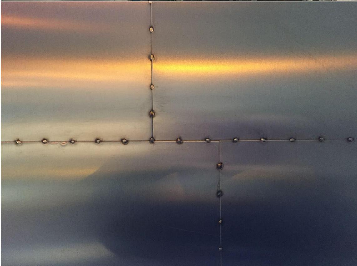
Como detalle constructivo, para ayudar a los esfuerzos a los que se somete la soldadura vertical que unirá las 2 partes del anillo, las chapas presentan un corte escalonado.
