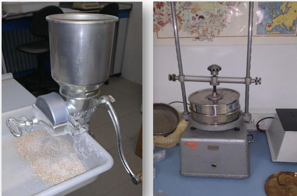
*Ilustración 1: Equipo de molienda y plasfinter*
