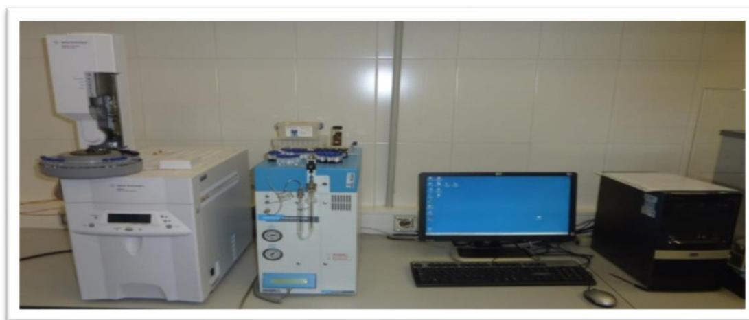
*Ilustración 9: Equipo Cromatógrafo de Gases (GC) 6850 (de la marca Agilent Technologies).*
