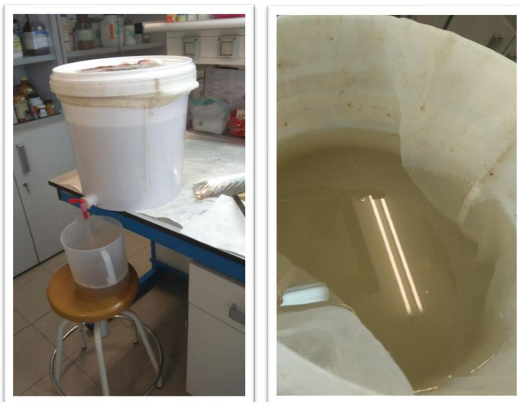
Ilustración 4: Proceso de filtrado, recirculación y vista dentro del tanque.
