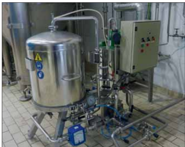
Foto 7. Filtro horizontal de platos de kieselguhr (BREW-TECH DCBL100/S). Planta Piloto AETCM.
