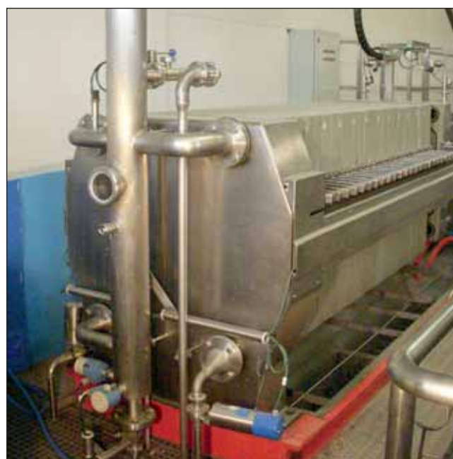
Foto 4a. Filtro prensa de membrana LANDALUCE LAMBDA-M. Planta Piloto AETCM.
