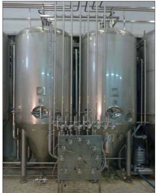
Foto 6. Tanques de Fermentación cilindro-cónicos. Planta Piloto AETCM.
