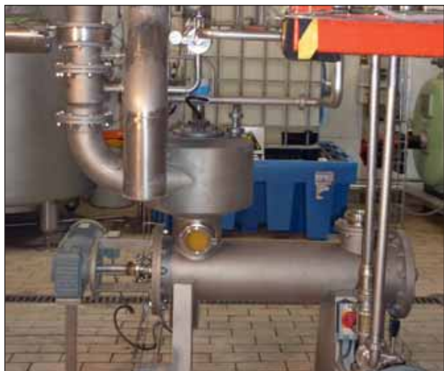
Foto 2. Pre-macerador automático horizontal LANDALUCE. Planta Piloto AETCM.
