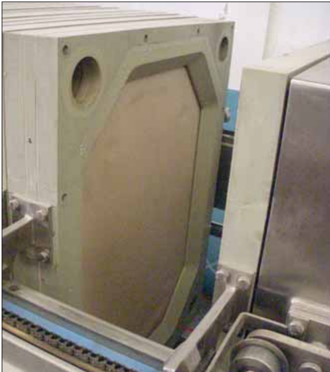
Foto 4b. Detalle de placa filtrante filtro prensa de membrana LANDA-LUCE LAMBDA-M. Planta Piloto AETCM.
