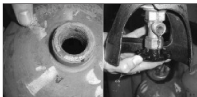
Figura 5. Ejemplos de corrosión y contaminación de un cilindro de gas.
