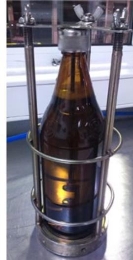
A la izquierda el aparato que se introducía en el Pasteurizador con un termógrafo que registraba el tiempo y temperatura, a que se sometía la botella dentro de los Pasteurizadores y ahora esos equipos son más sencillos con un sensor que recoge esas dos variables y se trasmite a un ordenador.
